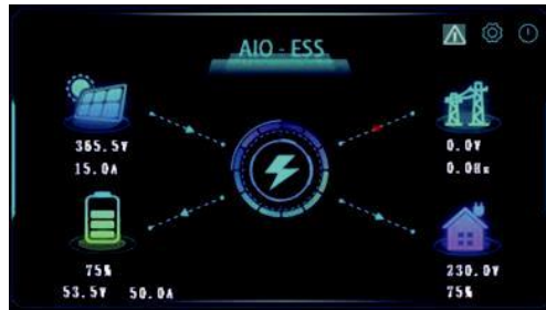
▲ انرژی خورشیدی توان را به بار تأمین کرده و باتری را شارژ می‌کند
