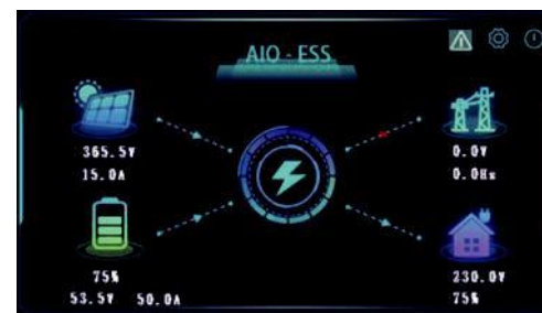
▲ باتری‌ها و انرژی خورشیدی توان را به بار تأمین می‌کنند.
