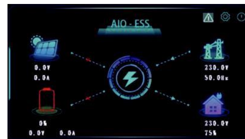
▲ ورودی AC توان را به بار تأمین می‌کند.
